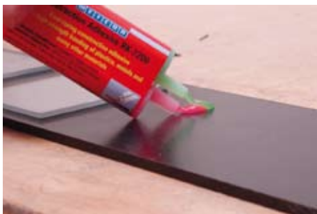
Verkleben von Dekorteilen aus Plexiglas (PMMA) im Bereich Messebau
