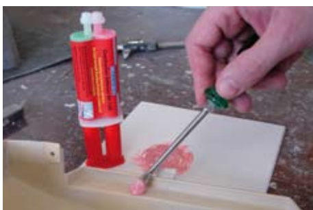
Aufkleben von Kunststoffstreifen auf Halbschalen aus GFK-Epoxy (Modellbau)
