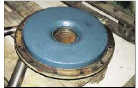
WEICON Keramik BL - Beschichtung eines Pumpengehäusedeckels
