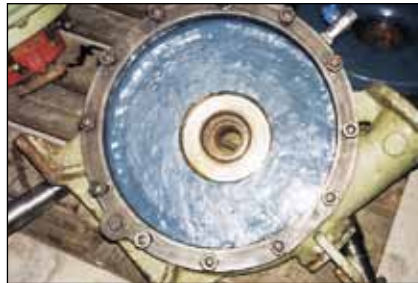
WEICON Keramik BL - Beschichtung eines Pumpengehäuses
