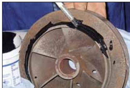
WEICON WR - Beschichtung einer Kreiselpumpe
