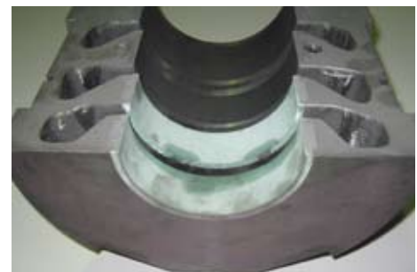
Reparatur von Dichtungsf lächen im Gehäuse einer Labyrinthdichtung Repair of sealing surfaces in a labyrinth seal housing
